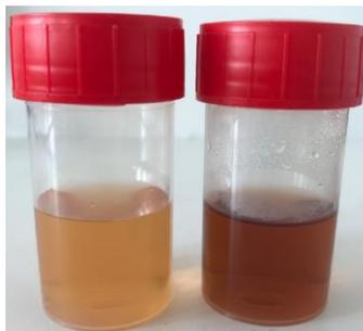
A gauche, échantillon protégé de la lumière, à droite, échantillon exposé 30 min
